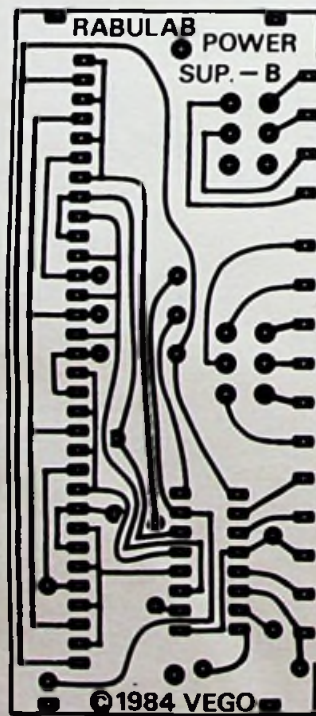
Afb. 7 Ontwerp van de bedieningsprint, schaal 1 : 1.
